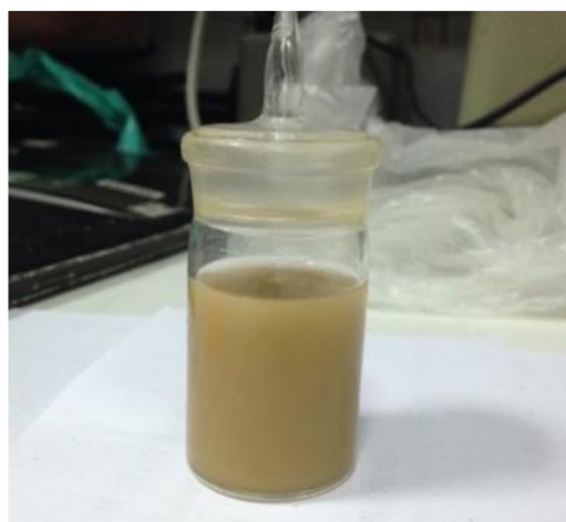
Рис. 6. Нанопорошок por-Si в изопропиловом спирте Fig. 6. Por-Si nanopowder in isopropyl alcohol
