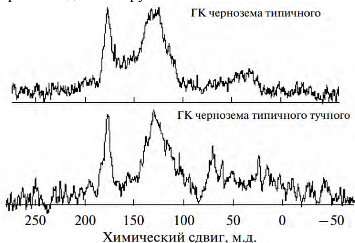
Рис. 2. ^{13}\text{C} -ЯМР спектры высокого разрешения ГК почв, полученные на спектрометре «Avance 400» компании «Bruker» с рабочей частотой 100 МГц [12]
