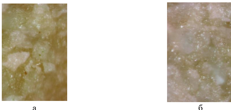
Рис. 2. Фотографии срезов ХДС до (а) и после испытаний (б), сделанных с помощью оптического модуля микроскопа «Наноскан-3D» Fig. 2. Photographs of CDS sections before (a) and after the tests (b), taken using the optical module of the Nanoscan-3D microscope
