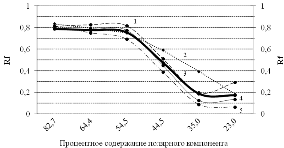
Рис. 3. Определение производных 3-(трифторметил)-анилина методом ТСХ при использовании подвижных фаз этанол-гексан: 1 – Ан, 2 – Фл, 3 – 4-Н-3-ТФМА, 4 – 4-А-3-ТФМФА, 5 – N-4-АА-3-ТФМФАА
