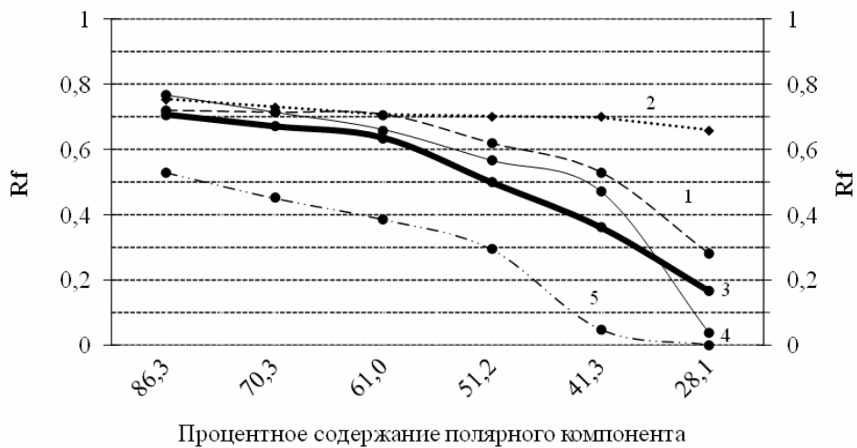
Рис. 4. Определение производных 3-(трифторметил)-анилина методом ТСХ при использовании подвижных фаз диоксан-1,4-гексан: 1 – Ан, 2 – Фл, 3 – 4-Н-3-ТФМА, 4 – 4-А-3-ТФМФА, 5 – N-4-АА-3-ТФМФАА
