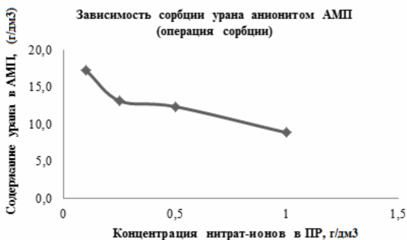
Рис. 3. Зависимость сорбции урана от концентрации нитрат-ионов на операции сорбции
