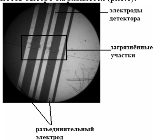
Рис. 6. Увеличенное изображение электрохимической ячейки
