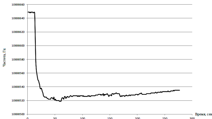
Рис. 1. Зависимость частоты колебаний сенсора на основе аскорбиновой кислоты от времени при внесении аммиака
