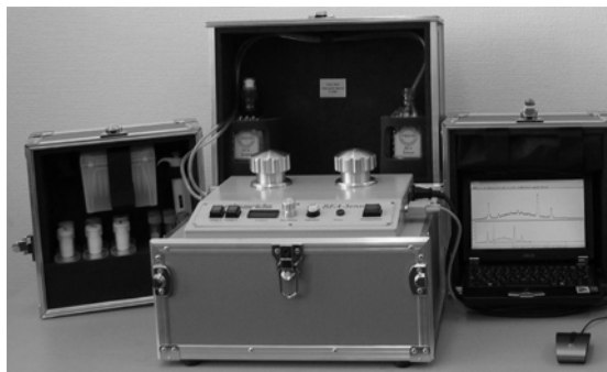
Рис. 5. Рентгенофлуоресцентный анализатор энергодисперсионного типа с сорбционной накопительной микросистемой
