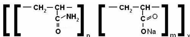
Рис. 1. Структура элементарного звена анионного полиэлектролита Praestol 2530
