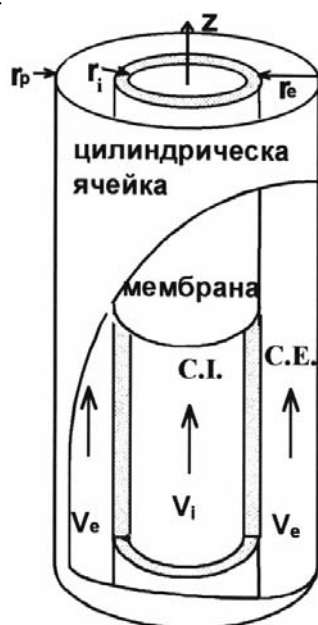
Рис. 1. Схема цилиндрической мембранной ячейки.
