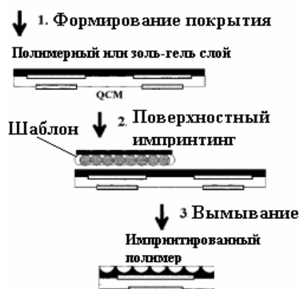
Рис. 7. Схема формирования распознающего слоя способом софт литографии
