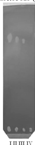
Рис. 1. Хроматографические профили реакционных смесей при синтезе имидазолина каприловой кислоты: 30 минут (I), 1 час (II), 2 часа (III), 3 часа (IV)
