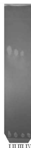
Рис. 2. Хроматографические профили реакционных смесей при синтезе имидазолина каприновой кислоты: 1 час (I), 2 часа (II), 3 часа (III), 4 часа (IV)
