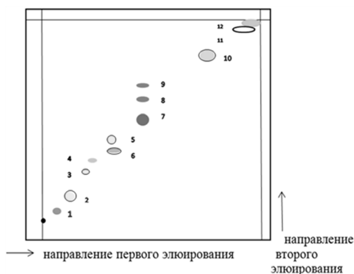
Рис. 7. Вид двумерной ТСХ извлечения из листьев облепихи крушиновидной (фаза заготовки 3) при просмотре в видимом свете и УФ 365 нм -свете (тип пластины ВЭТСХ-АФ-В)
