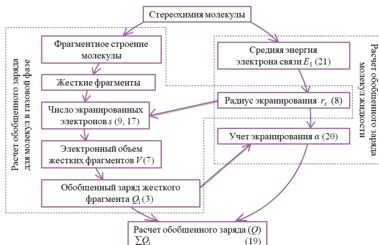
Рис. 2. Блок-схема порядка расчета обобщенного заряда для молекул в газовой среде (слева) и молекул конденсированной фазы (справа).
