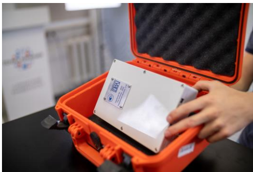
Рис. 1. Мобильный диагностический комплекс на основе микрофлюидных систем, оснащенный системой автоматического отбора пробы для экспрессного количественного определения ацетона в выдыхаемом воздухе при диагностике диабета
