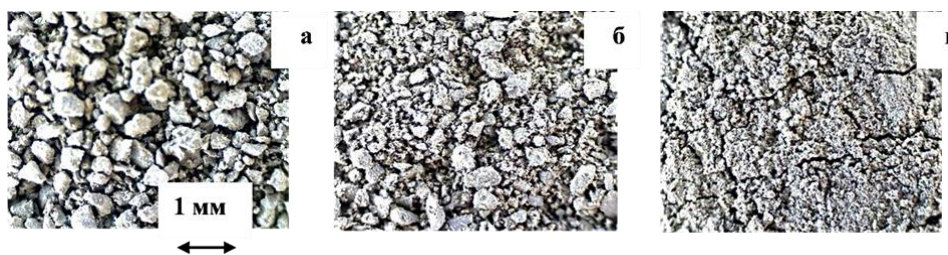
Рис. 2. Изображения поверхностей частиц глины в исходном состоянии (а), после 10 минут (б) и 20 минут (в) воздействия СВЧ-излучения Fig. 2. Surface of clay particles in the natural state (a), and after 10 (b) and 20 minutes (c) \ under MW radiation
