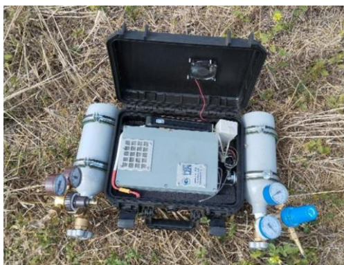
Рис 1. Мобильный аналитический комплекс на базе портативного хроматографа «ПИА»
