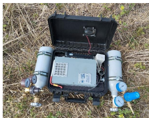
Рис. 2. Мобильный аналитический комплекс на базе портативного хроматографа «ПИА» производства ООО «НПФ МЭМС», г. Самара.
